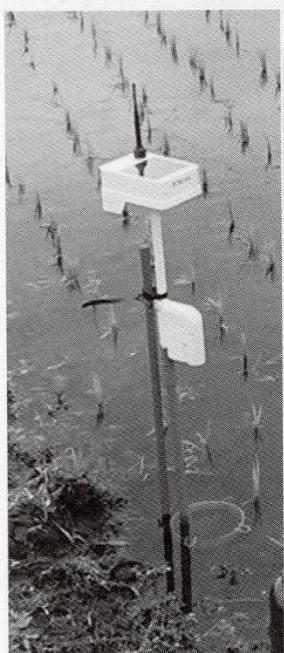
図6 水田内に設置した水位センサ
