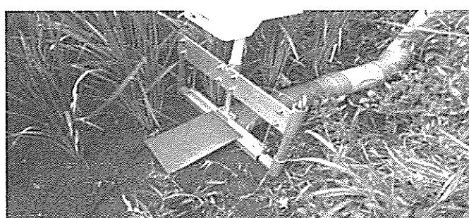
図7 給水ゲートで配水操作（給水、停止作業）を自動化
